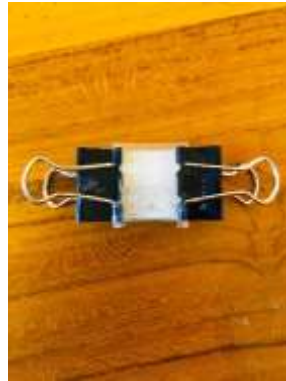
Gambar 3. Struktur DSSC Pada Penelitian Ini
