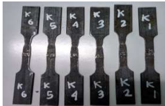
Gambar benda uji spesimen bentuk kampuh K
