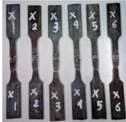
Gambar benda uji spesimen bentuk kampuh X
