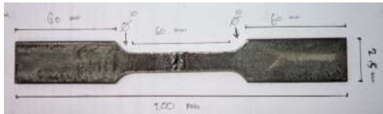
Gambar Dimensi Ukuran benda uji bentuk kampuh X.
